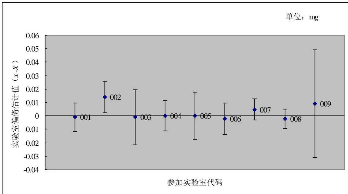
图 B5 200 mg 砝码校准能力验证计划结果图示（以实验室结果作图）
